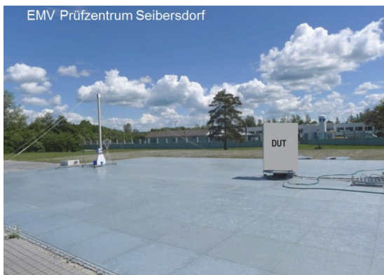
Freifeldmessgelände mit bis zu 10m Messstrecke
